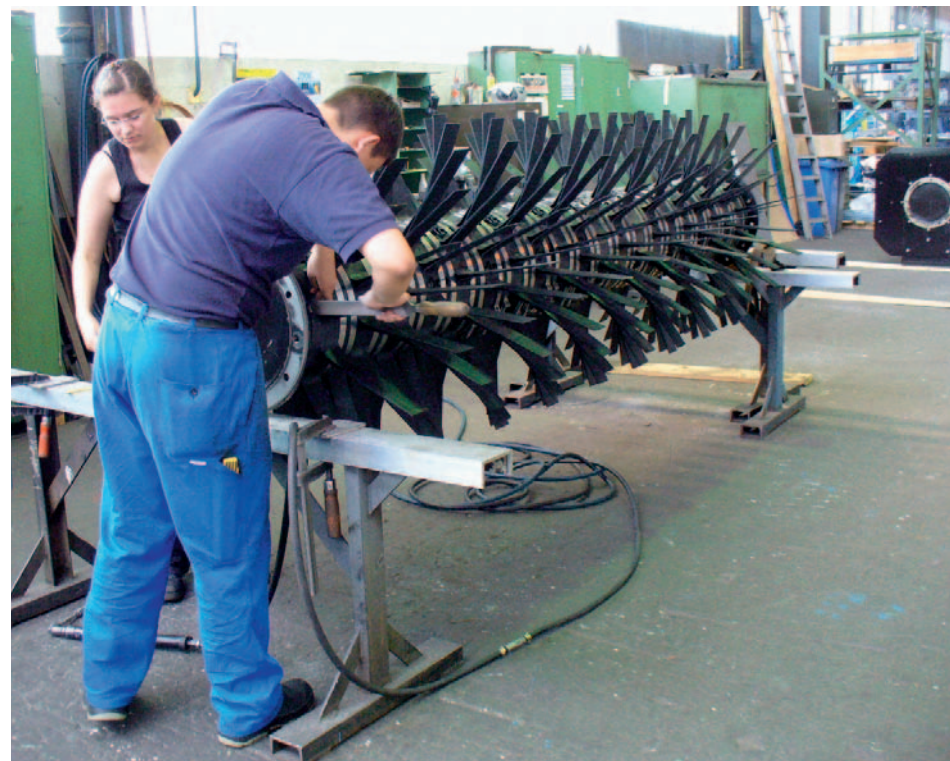
Montage einer Lüftungswalze für Belebungsbecken in Abwasseranlagen. Die Schrauben liefert der Dienstleister Lederer, Spezialist für Verbindungselemente
