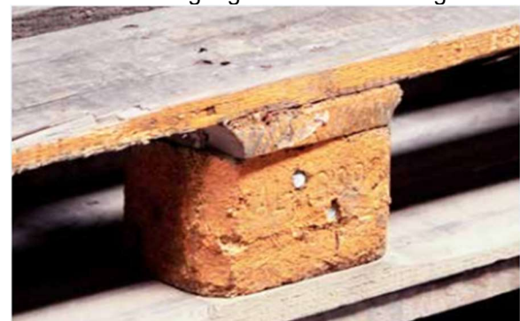
Verunreinigungen z.B. Farbe, Öl, Schimmel
